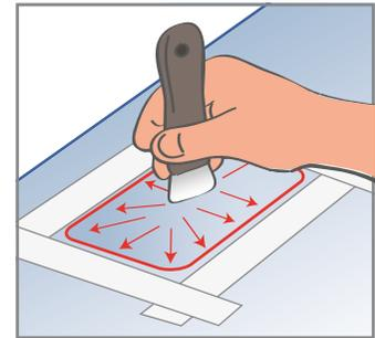
8. Den restlichen Kleber mit Härter mischen. Oberfläche des Gewebes mit dem Lösungsmittel abwischen, ein zweites Mal mit dem Lösungsmittel über das Gewebe wischen, bis es klebrig/schmierig wird. Dann eine erste dünne Lage Kleber auftragen, 30 Minuten warten und eine zweite dünne Lage Kleber auftragen.
