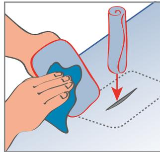
2. Die Oberseite des Flickens und des Schlauches, auf die der Kleber aufgebracht wird, mit dem mit P510 Lösungsmittel befeuchteten Tuch abwischen. Das Lösungsmittel ablüften (verdunsten) lassen und erneut über die Oberseite wischen. Die Oberfläche muss klebrig werden. Ablüften lassen.
